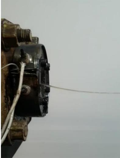
En cuanto fue extraído el filamento de la boquilla, se pasó por una piscina con agua precalentada (Figura 13) a una temperatura aproximada de 45°C, para disminuir el gradiente de enfriamiento del material.
