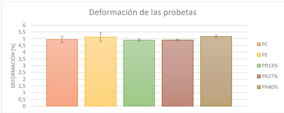
De la Figura 50, no hay variación significativa entre los valores de deformación, para los grupos de probetas ensayadas.
