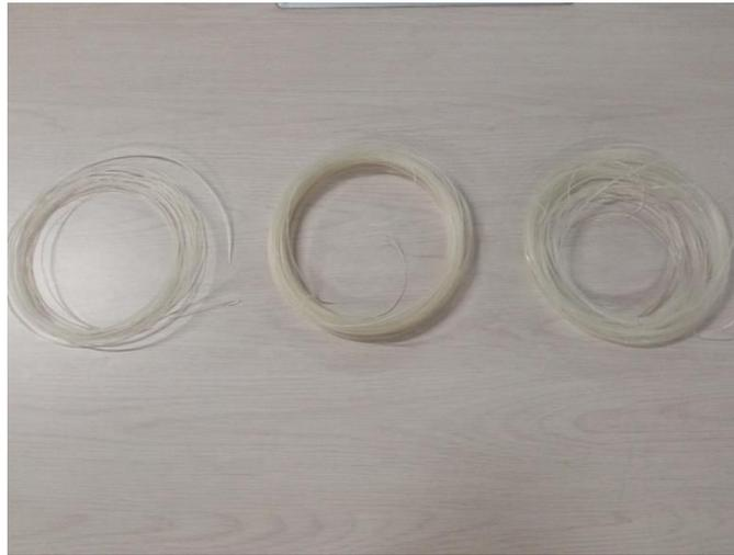
Para los cuerpos de prueba, se seleccionaron los tramos con el diámetro más uniforme, Tabla 7. La longitud de los cuerpos de prueba o filamentos para el ensayo de tracción fue de 100 mm de los que se marcaron 12 mm en cada extremo para la sección de agarre de las mordazas, esta medida se obtuvo a partir de la norma ASTM D3822. Finalmente, se prepararon 14 tramos de los que se descartaron 4 por tener marcas superficiales y se aprobaron 10 tramos para la realización del ensayo, Figura 15.
