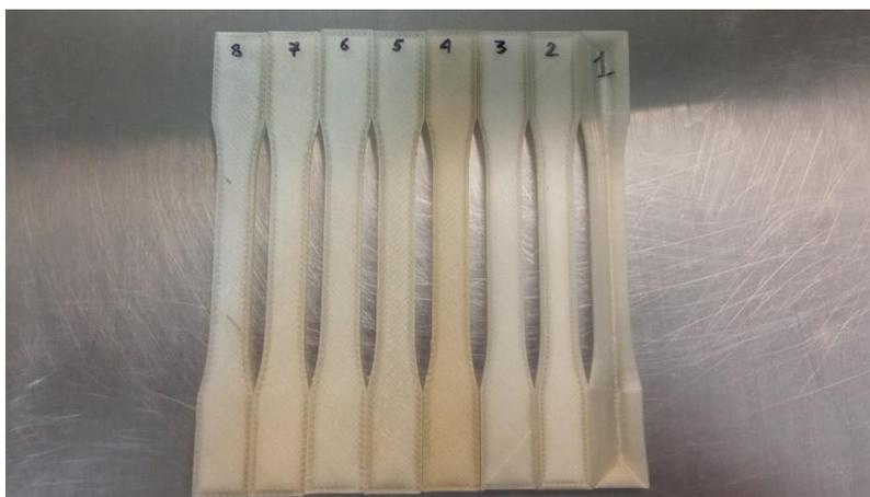
Finalmente se realizó una inspección de los cuerpos de prueba para identificar posibles irregularidades que afectarían los ensayos, se verificaron y validaron las dimensiones de acuerdo
