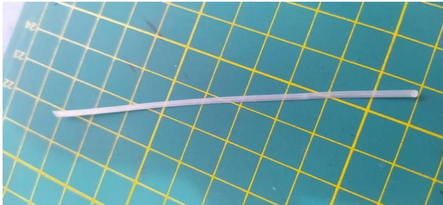
Una vez se obtuvieron los hilos extruidos se verificaron las dimensiones de estos, de forma que cumplieran con los parámetros requeridos por la norma ASTM D-3822. En total, se fabricaron 14 unidades de filamento compuesto, de las que se rechazaron 4 unidades por
