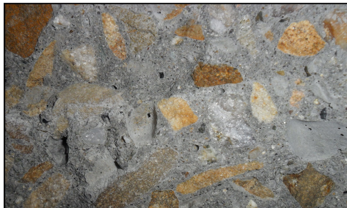
Figura 14. Apariencia interna de probeta alterada
