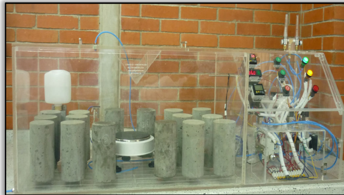
Figura 7. Curado de probetas en cámara
