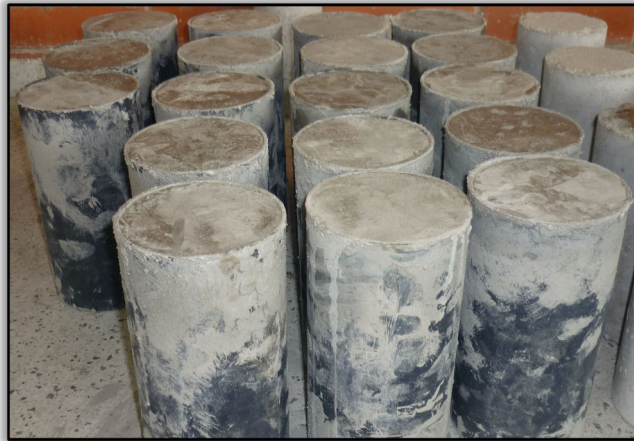
Figura 6. Fraguado de las probetas al ambiente
