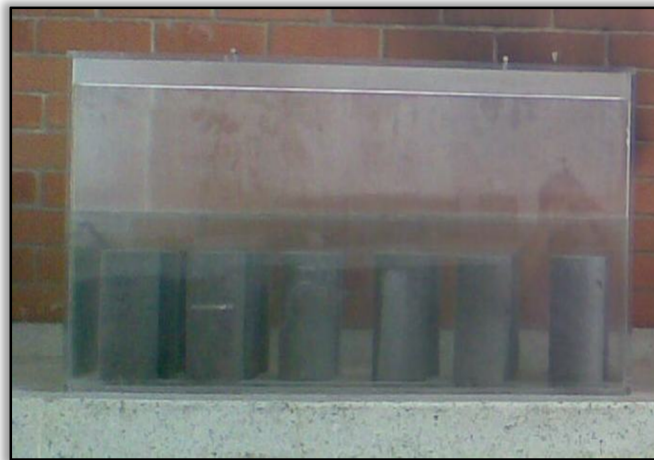
Figura 8. Curado de probetas en condiciones estándar
