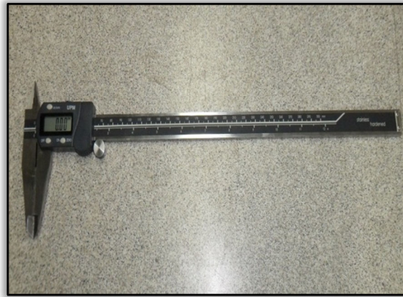
Figura 9. Calibrador digital utilizado para tomar medidas en las probetas testigo
