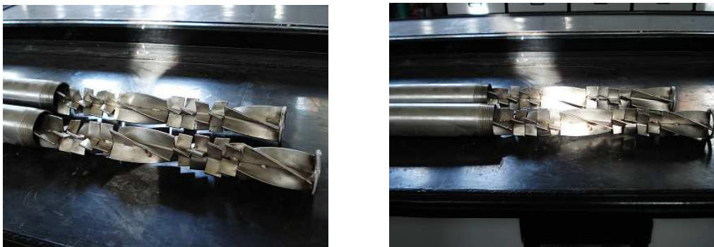
Figura 12. Sistema de Mezclado (inyección de CO 2 )
