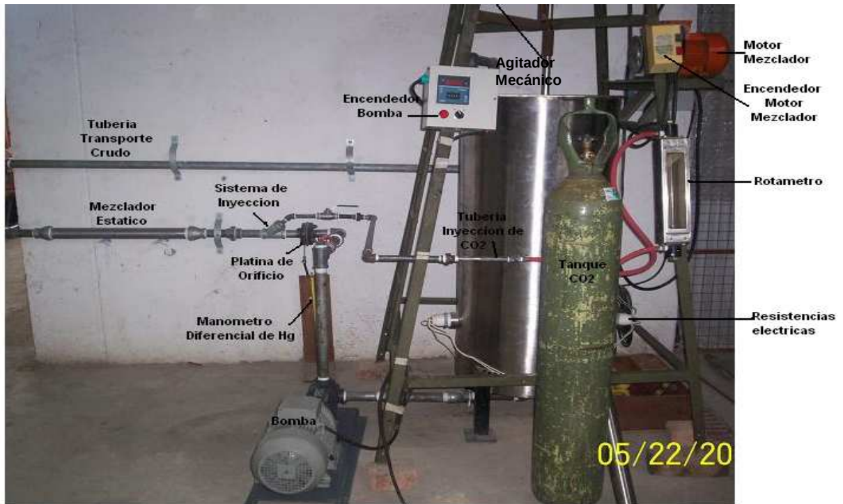
Figura 7. Montaje Planta Piloto (Sistema de Pruebas)
