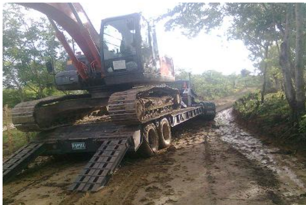
Figura 18. Movilización de retroexcavadora Hitachi
