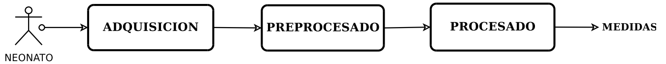
Figura 1.1: Diagrama de bloques general de las etapas llevadas a cabo para detectar singularidades y puntos característicos de la señal ECG neonatal
