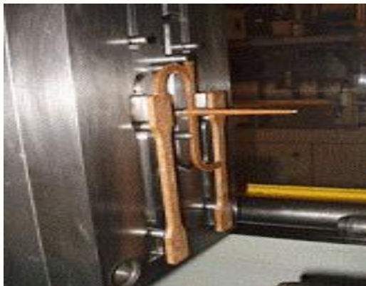
Figura 3. Pieza de madera y plástico en un molde de inyección
