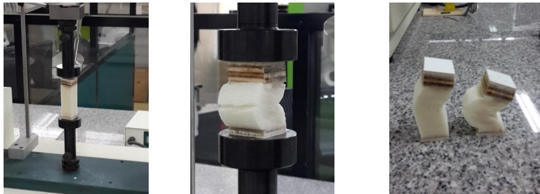
Figura 26. Ensayo de compresión Estructura interna Piso - Prueba
