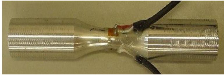
Figura 10. Fotografía de una probeta de ensayos de vida a fatiga.
