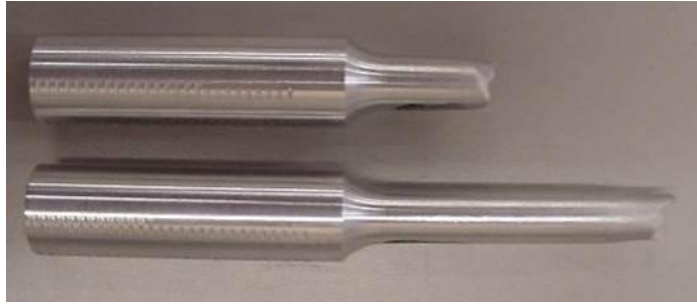
Figura 13. Probeta rota durante ensayo de tracción, vista lateral.
