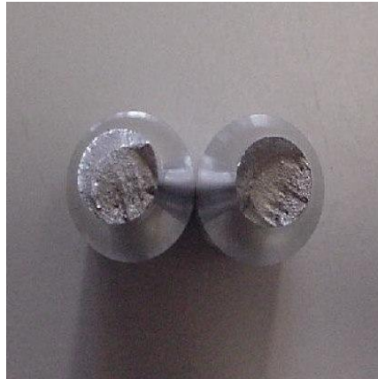
Figura 18. Probeta rota durante un ensayo de vida a fatiga, vista frontal
