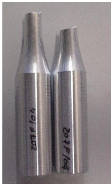
Figura 17. Probeta rota durante un ensayo de vida a fatiga, vista lateral.
