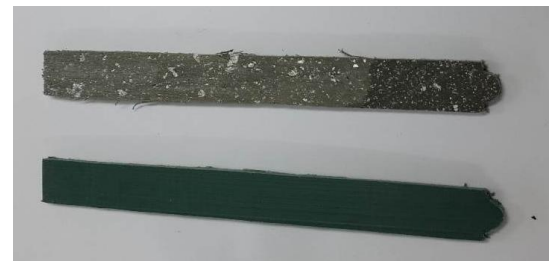
Molde probeta de Flexión Ancho:12,7mm Largo:127mm Espesor: 3,2mm
