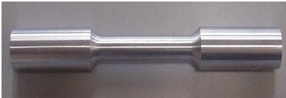
Figura 8. Fotografía de una probeta de ensayo de tracción.
