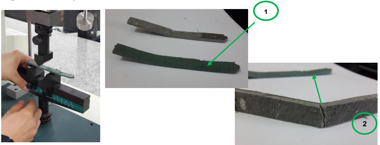
Figura 24. Ensayo de flexión – Prueba
