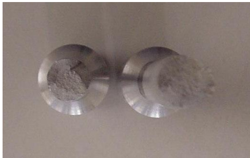
Figura 14. Probeta rota durante ensayo de tracción, vista frontal.
