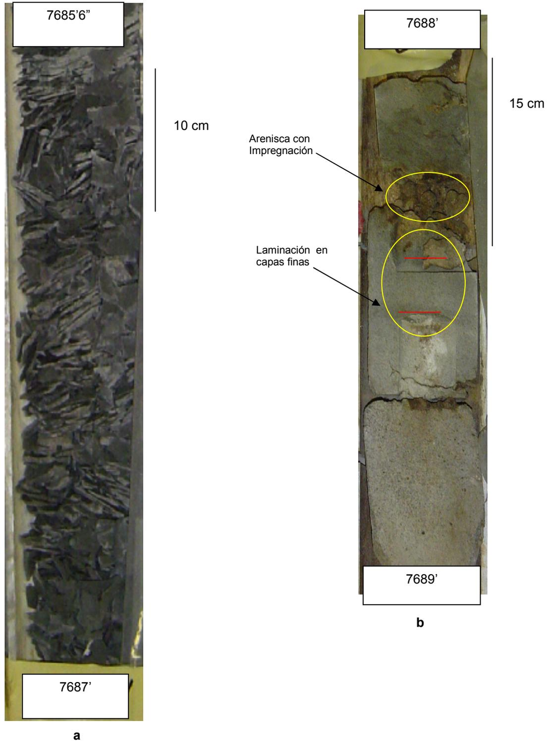
**Fotografía 4.** Fotografías representativas del corazón del Pozo B. (a) Shales negros, silíceos. (b) Cuarzoareniscas esparíticas.
