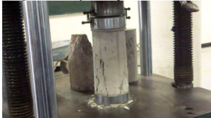
Figura 12. Ensayo a compresión del concreto
