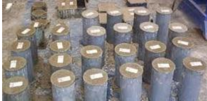
Figura 11. Muestras de concreto, enviadas posteriormente a ensayo
