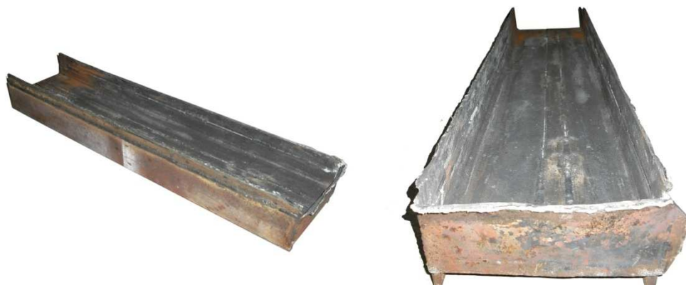
Figura 32. Formaleta construida para realizar la fundición.
