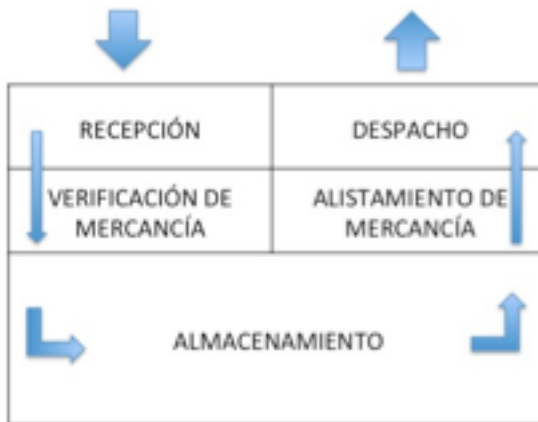
Figura 2 Diseño de bodega en U
