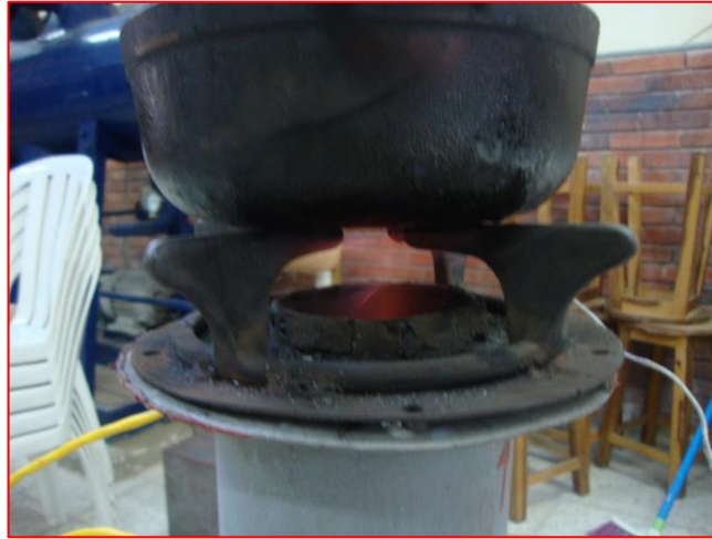
Figura 51. Rediseño de la Salida de Gas del Quemador
