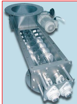
Figura 32. Transportador de Tornillo Doble Usado en la Industria Química y de Alimentos
