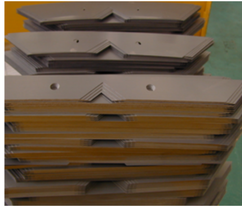
b) Corte de las láminas de los yugos
