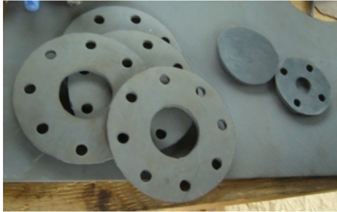
Figura 3.33: Empaques de las juntas o uniones Fuente: Autora del Proyecto
