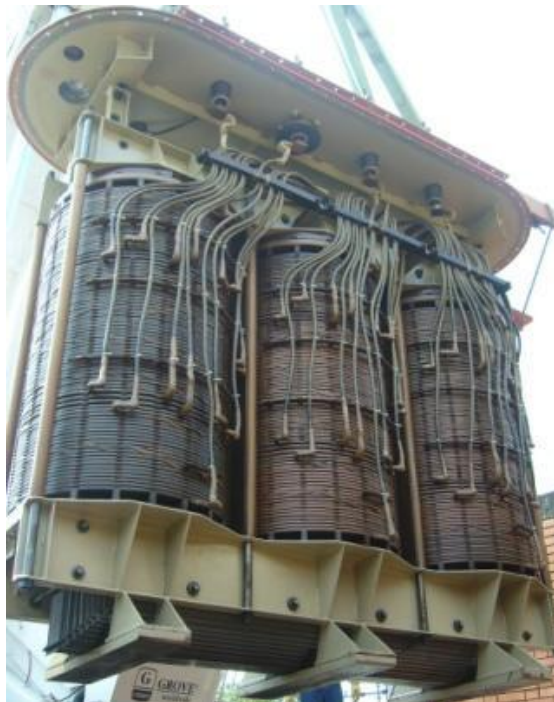
Figura 3.19: Parte Activa del Transformador. Cambiador de Taps o Derivaciones Fuente: Autora del Proyecto
