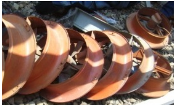
Figura 3.23: Ventiladores que complementan el tipo de enfriamiento Fuente: Autora del Proyecto
