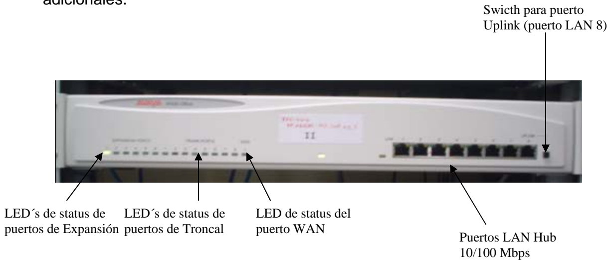
Figura 1-3. Vista frontal del IP OFFICE 406 (Fuente: Fotografía tomada por el autor)
