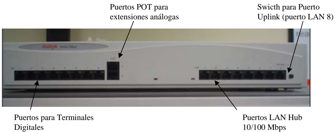
Figura 1-1. Vista frontal del IP OFFICE 403 (Fuente: Fotografía tomada por el autor)
