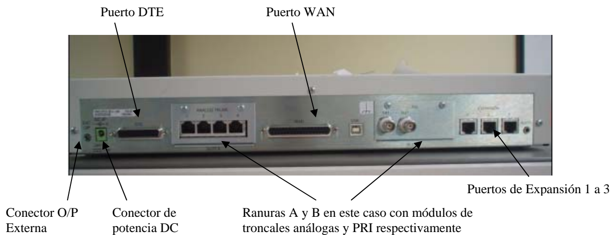
Figura 1-2. Vista posterior del IP OFFICE 403 (Fuente: Fotografía tomada por el autor)
