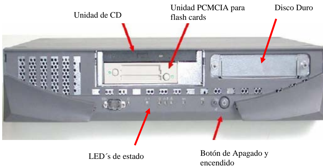
Figura 1-24. Servidores S8700, vista frontal sin tapa (Fuente: Ver [28])
