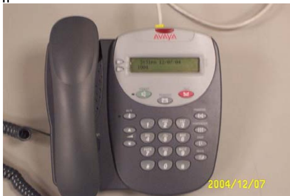
Figura 1-21. Teléfono Modelo 4602IP (Fuente: Fotografía tomada por el autor)
