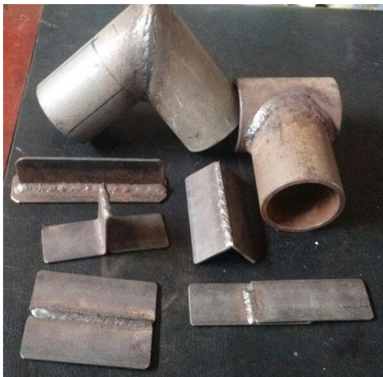
Figura 35. Muestrario juntas soldadas
