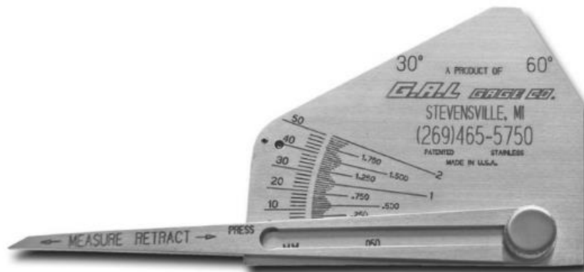
Figura 42. Medidor de soldaduras sesgadas
