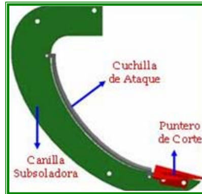
Figura 93. Elementos del conjunto canilla subsoladora.
