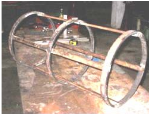
Figura 116. Estructura Rodillo Desterronador.
