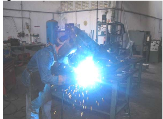
Figura 107. Soldado final del bastidor.
