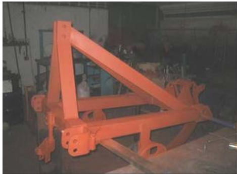
Figura 125. Prototipo con imprimante anticorrosivo
