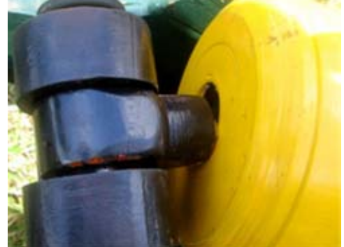
Figura 138. Flexión Tornillo Fusible inducido por el giro del pasador
