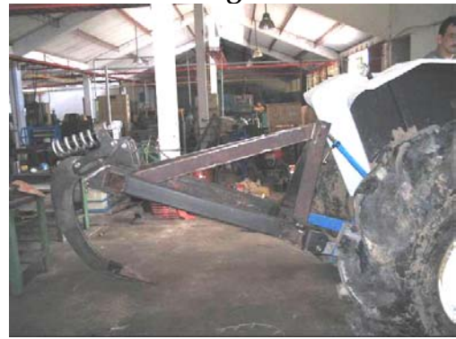
Figura 118. Equipo diseñado montado en el sistema de enganche tractor.
