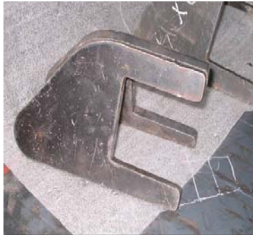
Figura 102. Enganche posterior para rodillo desterronador.
