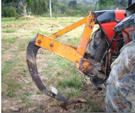
Figura 97. Canilla a máxima capacidad de penetración.
