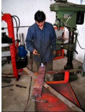
Figura 104. Calentamiento platina para doblado.
