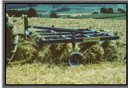
Figura 11. Subsolador montado en la barra portaherramientas.
