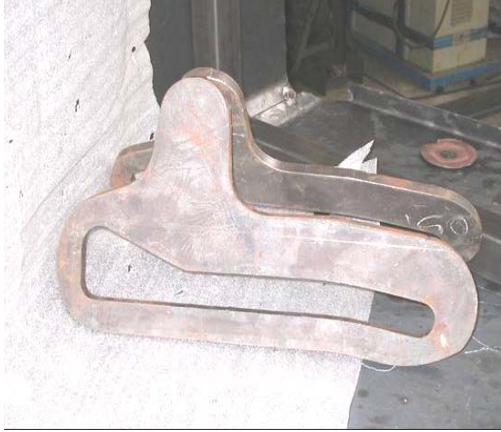
Figura 110. Perfiles Cortados para Estructura fusible reposicionador.
