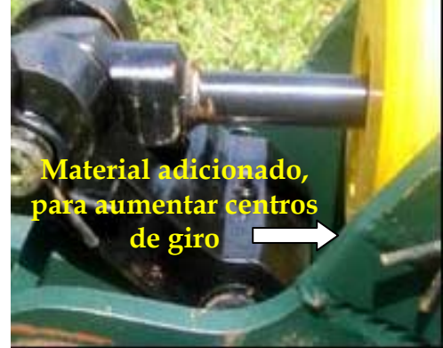
Figura 136. Correcta rotación de par cinemático Manivela-Tornillo
