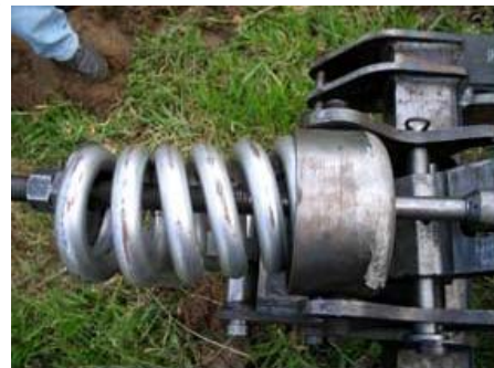
Figura 124. Pandeo del Resorte Reemplazador.
