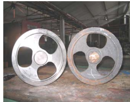
Figura 109. Ruedas control de profundidad.
