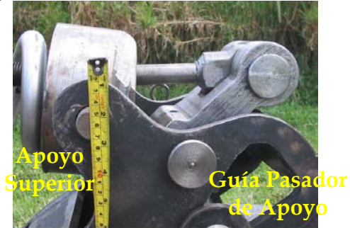
Figura 121. Revisión distancias centros de giro.
