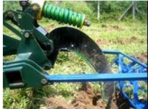
Figura 140. Colisión interna entre Canilla y Estructura Fusible.
