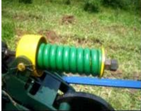
Figura 135. Resorte a máxima compresión sin presentar pandeo
