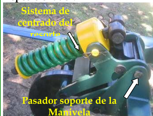
Figura 129. Subconjunto Fusible Reposicionador.
