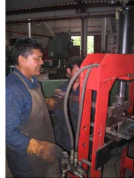
Figura 105. Doblado en prensa hidráulica de platina
