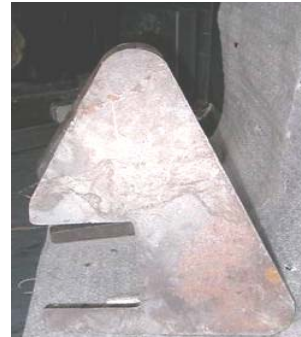
Figura 103. Enganche posterior para canilla subsoladora.
