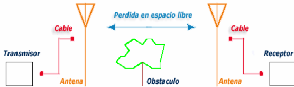
Figura 4. Elementos a Considerar al Calcular la Zona de Fresnel
