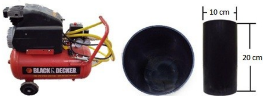
Figura 14. Compresor y formaletas utilizados en la fabricación de las probetas. Tomado de [23].
