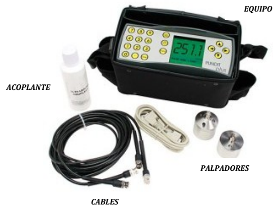
Figura 11. Equipo PUNDIT PLUS PC 1006. Tomado de [ http://www.jroma.pt/images/punditplus.jpg ].
