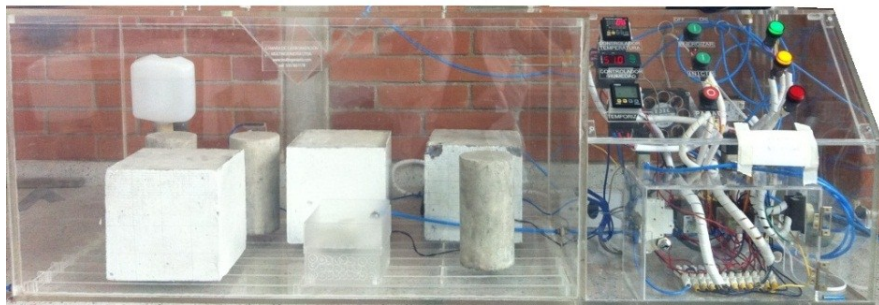
Figura 22. Disposición de las probetas de relación a/c 0.55 para las pruebas preliminares.
