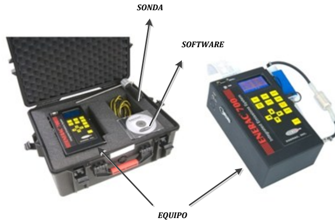
Figura 9. Equipo ENRAC 700 (ENRAC INC). Tomado de [ http://www.aikencolon.com/enerac-700-combustion-emission-system.html ].
