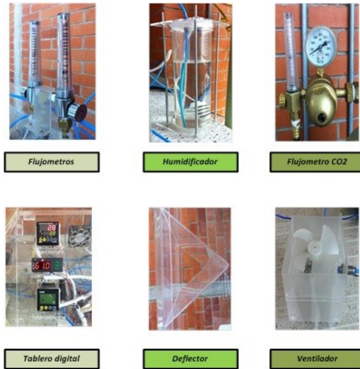
Figura 10. Otros componentes de la cámara de carbonatación.
