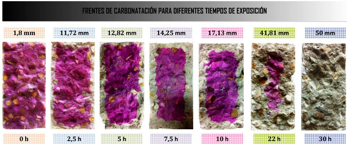
Figura 28. Profundidades de carbonatación obtenidos en diferentes tiempos de exposición, para concretos con relación a/c de 0.8, bajo un 70 % de dióxido de carbono.
