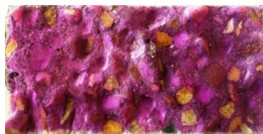
Figura 23. Frente carbonatado en concreto de relación a/c 0.55 con 12 horas de exposición.
