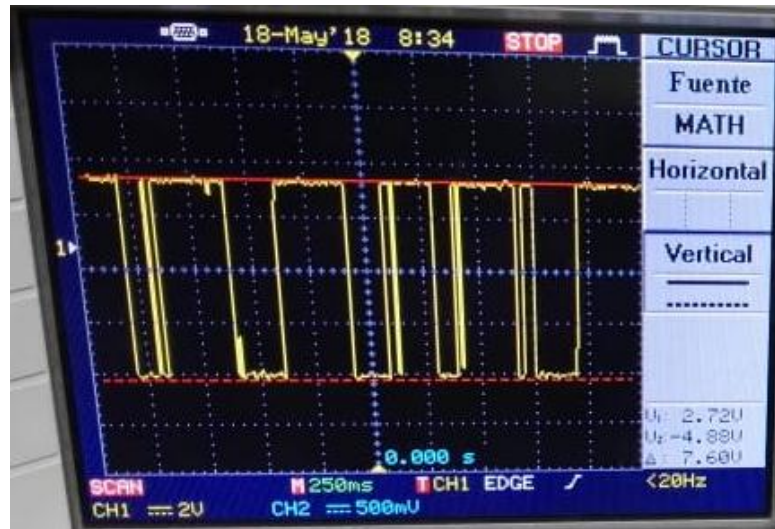
Fotografía 28. Vista de señal generada prueba C y medición de tensión pico a pico.
