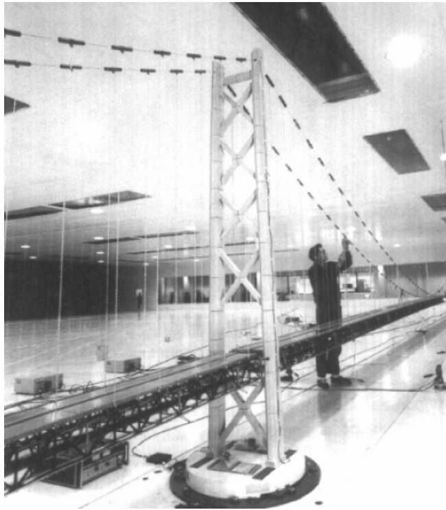
Figura 28. Modelo completo del Puente sobre el estrecho de Akashi a escala 1/100
