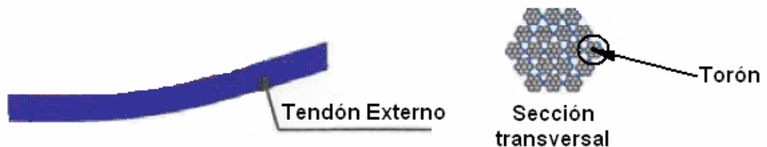
Figura 15. Esquema de los Tendones de preesfuerzo para cables extradadosos
