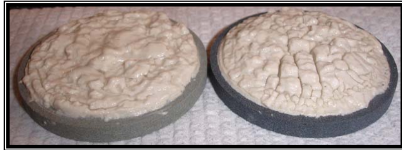
Figura 65. Cake formado con KCl - GEM GP a 1000 psi y 200°F.
