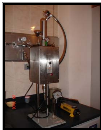
Figura 63. Montaje prueba de PPT.
