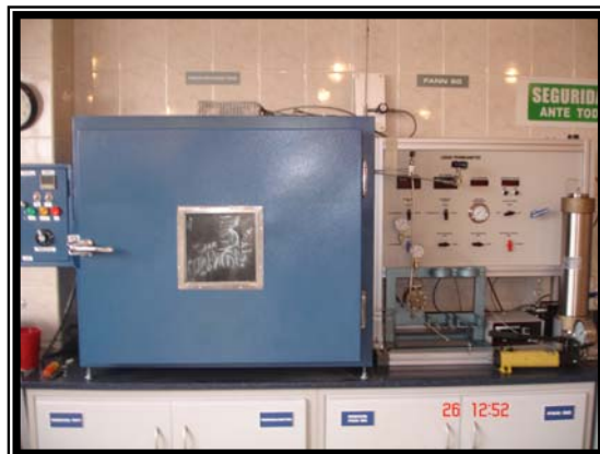
Figura 80. Montaje de la Prueba de Retorno de Permeabilidad.
