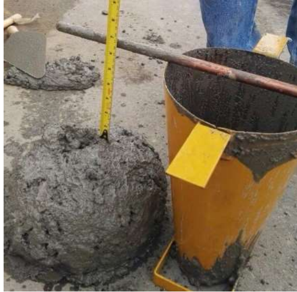
Figura 14. Asentamiento del concreto en obra. Nota. Tomado de: INSUT SAS.
