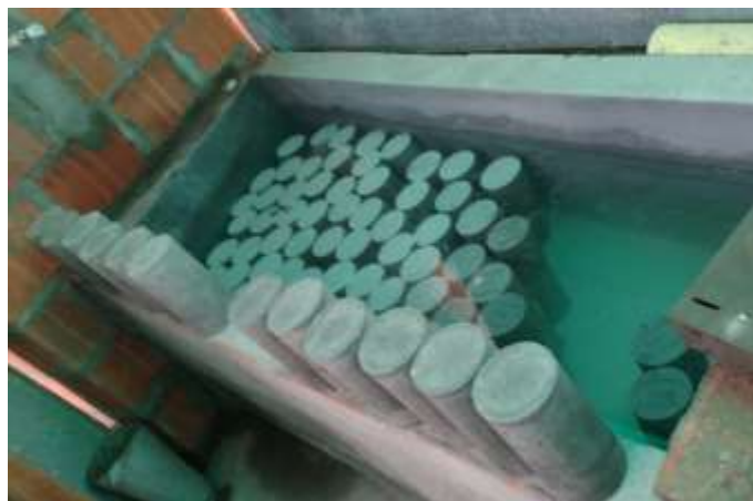
Figura 17. Proceso de curado de muestras para laboratorio. Nota. Tomado de: INSUT SAS
