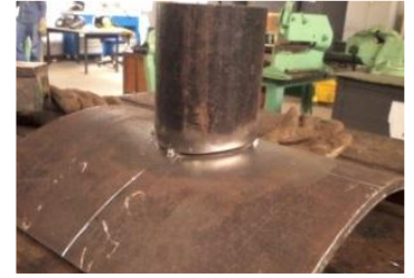
f. Montaje: puntos de soldadura
