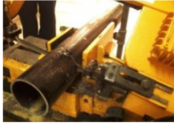
a. Corte tubería
