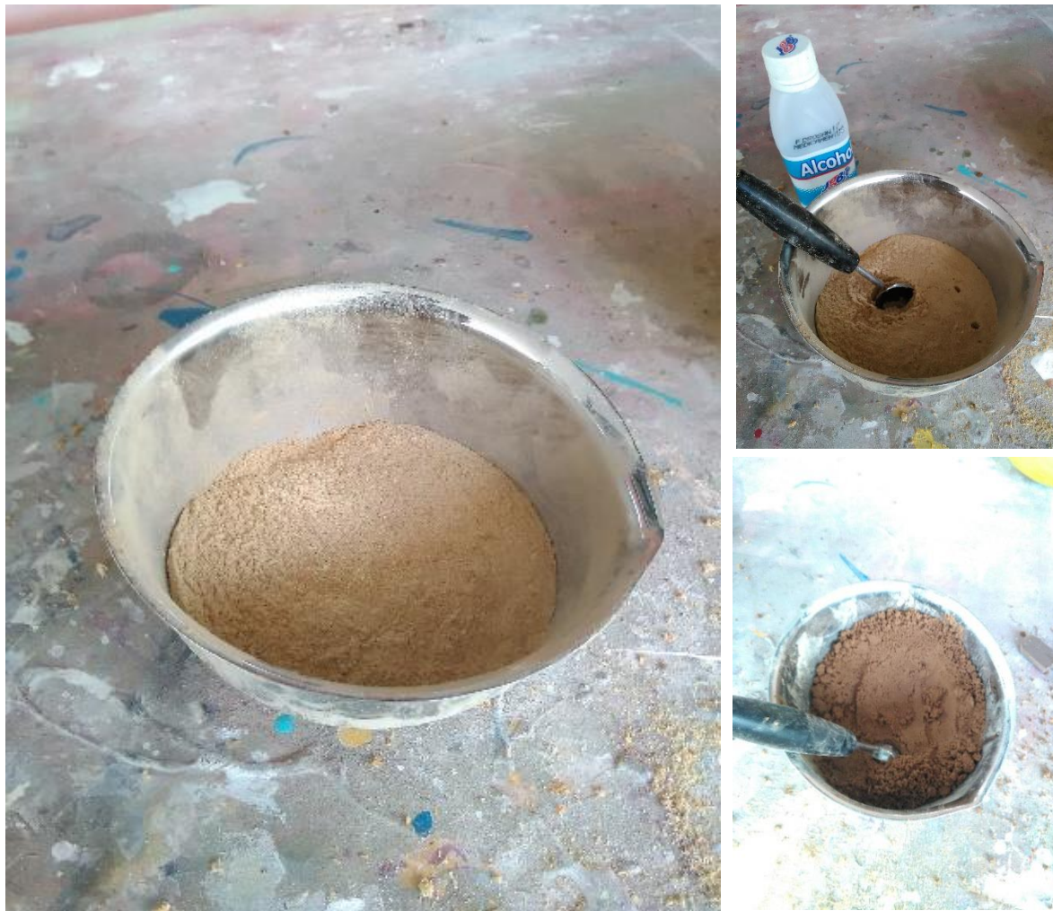
Figura 44. Masa de aserrín alcohol y aceite para crear pila de combustión.
