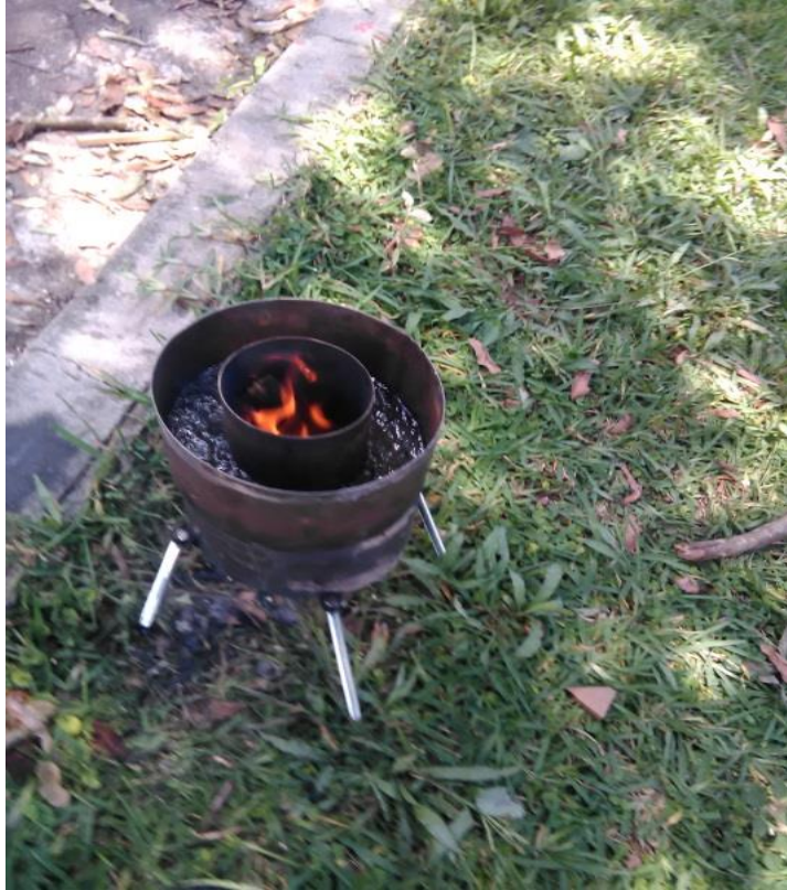
Figura 43. Dispositivo encendido con pila y madera seca
