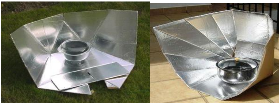
Figura 14. Cocina solar DSPC y cocina Solar El fun panel, Tomado de: Red global de cocina solar. Recuperado de: http://es.solarcooking.wikia.com/wiki/Red_Global_sobre_la_Cocina_Solar
