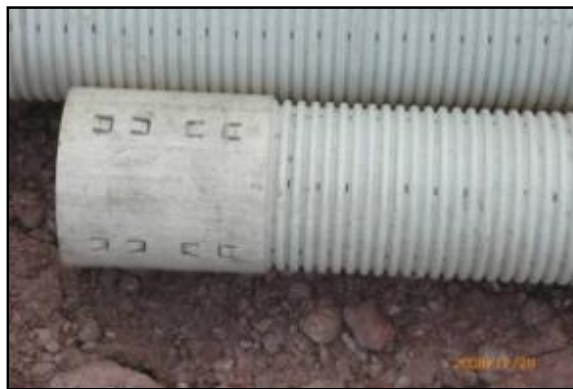
Figura 73 Detalle tubería PVC filtro.
