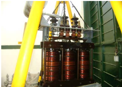
Figura 1. Ejemplos de núcleos de transformadores. a) Tipo columna (Core type), b) Tipo acorazado (Shell type)
