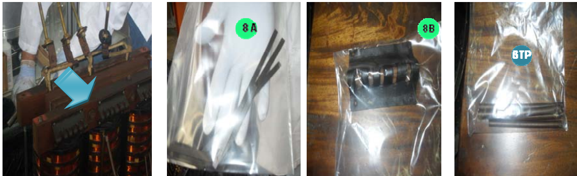
6. Recolección de papel y cartón del tornillo pasante y su base (muestras 8A, 8B y 6TP).
