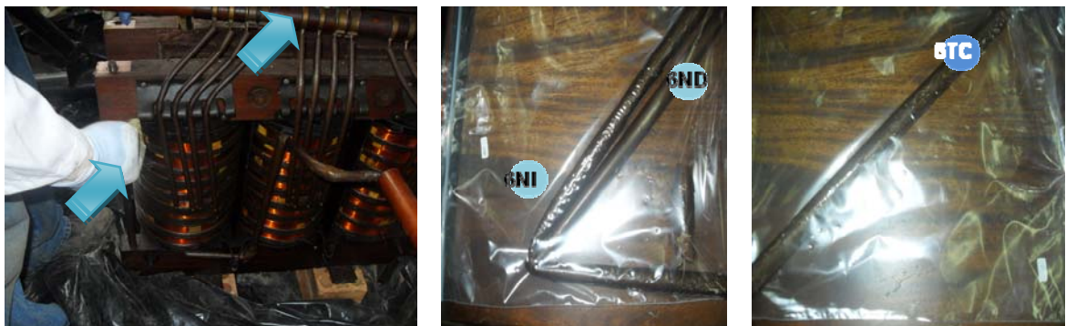
7. Recolección de papel que recubre los sostenes laterales del núcleo y el tubo de conmutación (muestras 6NI, 6ND y 6TC).
