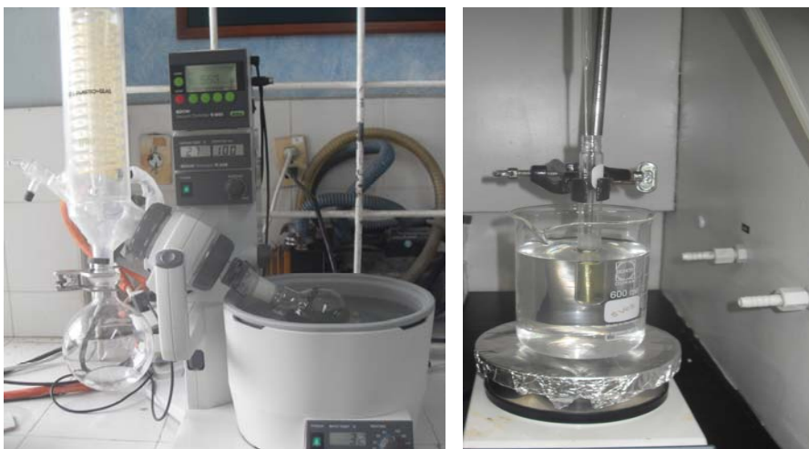
Figura 11. Eliminación del solvente del extracto Soxhlet, a). Destilación simple y b). Concentración con nitrógeno
