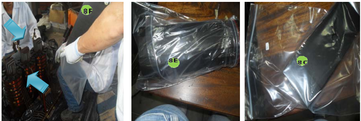
9. Recolección de cartón separador de devanadas de alta y baja tensión, separador de columnas y separador de yugos (muestras 8F, 8E Y 8C).
