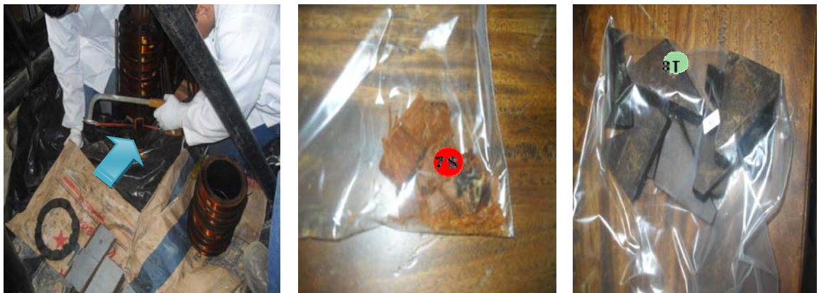
10. Recolección de madera y triángulos de cartón, elementos de sostén del núcleo (muestras 7I, 7S Y 8T).
