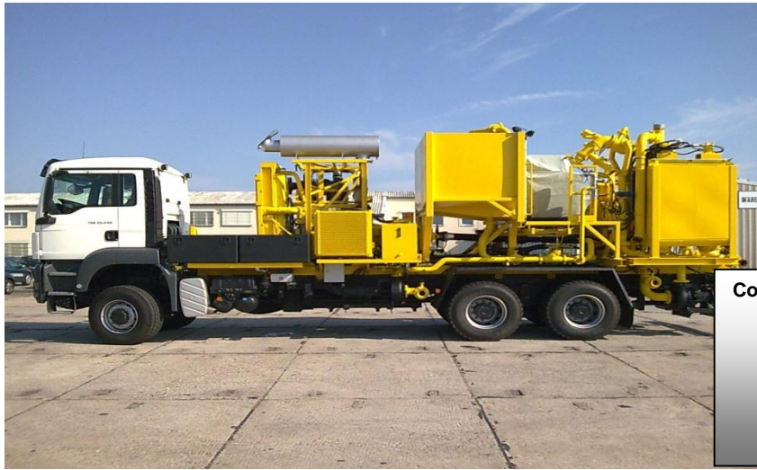
Ilustración 14. Unidad Cementadora propiedad de la empresa Bronco.
