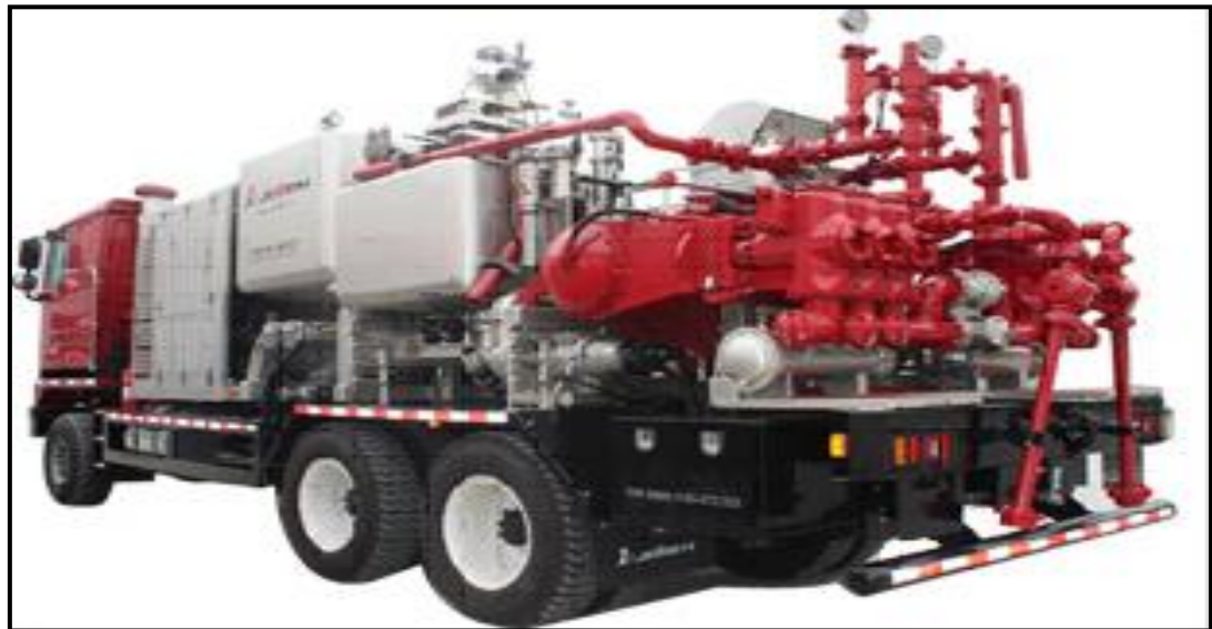
Ilustración 15. Unidad de Cementación estándar propuesta
