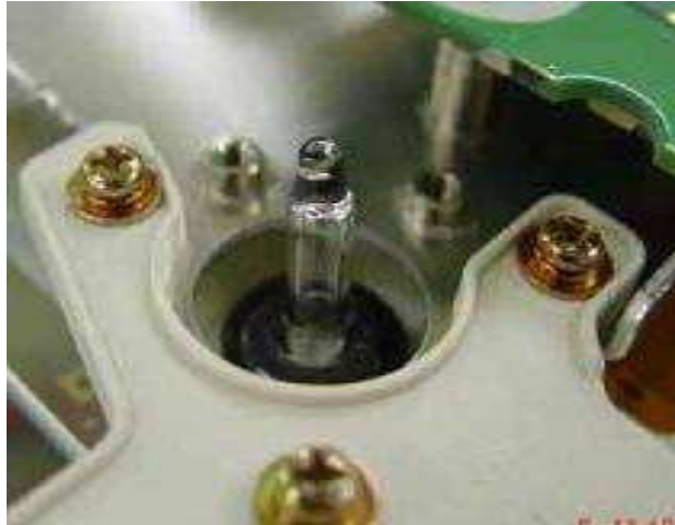
Figura 54. Punta de inyección del gas de un televisor PDP Fuente: LG Service Manual PDP4294LV1
