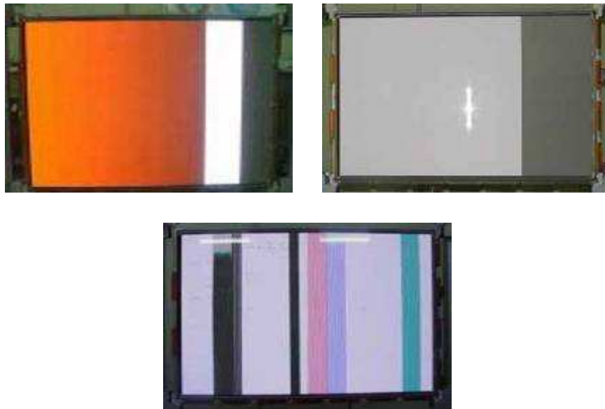
Figura 60. Defectos de la pantalla con barras horizontales Fuente: LG Service Manual PDP4294LV1
