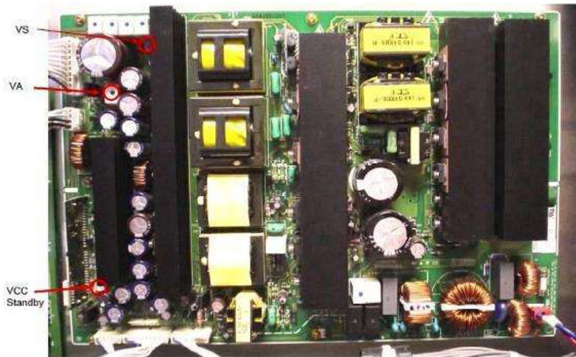
Figura 48. Puntos de prueba en la Power Board de un TV PLASMA Fuente: LG Training Manual 50PY2DR
