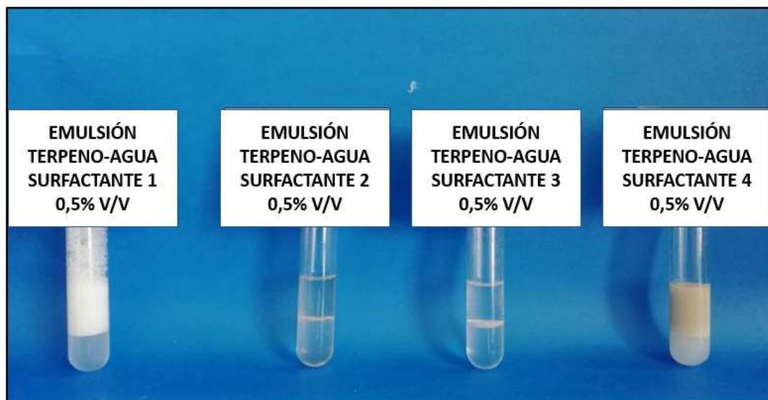
Figura 15. Estabilidad de la emulsión a concentración alta de surfactante.
