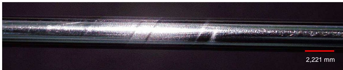
Figura N° 49. Nucleación y crecimiento de bandas de martensita
