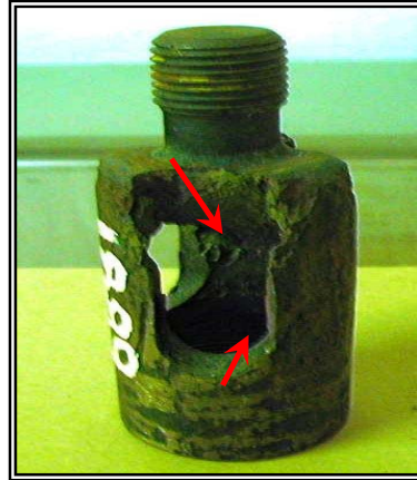
Figura D16. Picaduras y hendiduras en el C11
