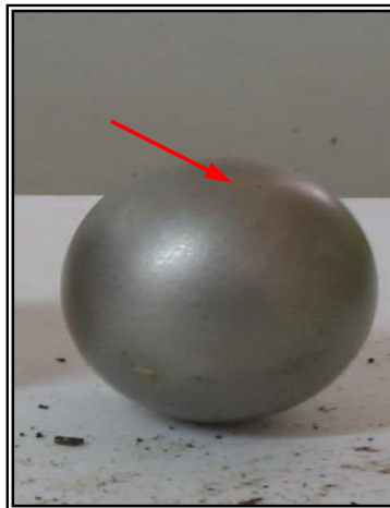
Figura D7. Bola desgastada por el gas y la arena
