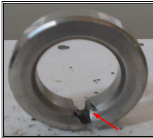
Figura D6. Asiento desgastado por el gas y la arena
