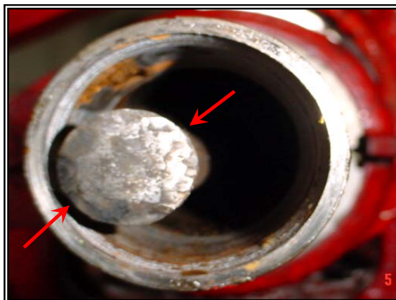
Figura C32. Precipitación de carbonatos en las bombas de subsuelo
