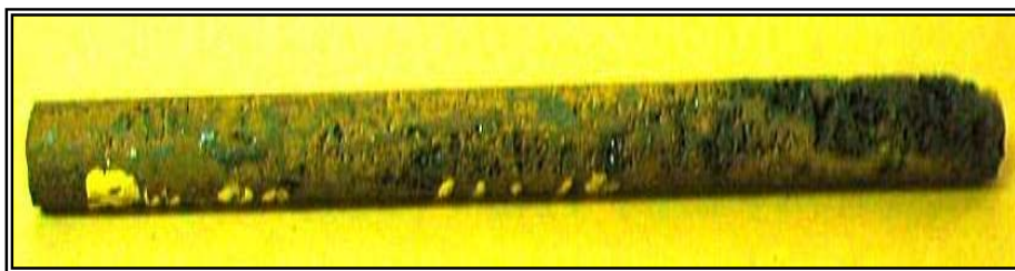
Figura D12. Corrosión localizada en varilla de recorrido de bomba (R11)
