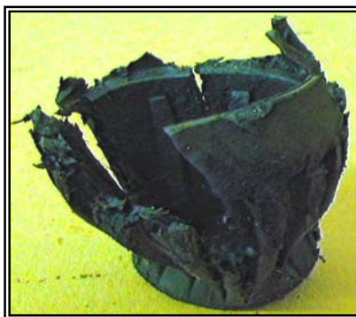
Figura C20. Protector encontrado en válvula viajera de bomba TH
