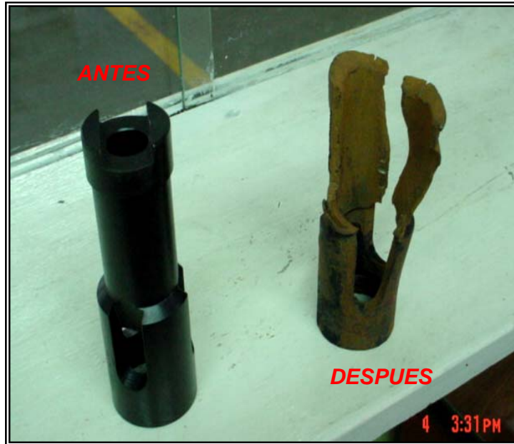
Figura D27. Golpe de bomba en el G11
