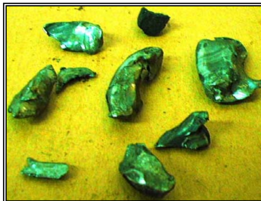
Figura D23. Restos metálicos encontrados en las cajas de la bomba
