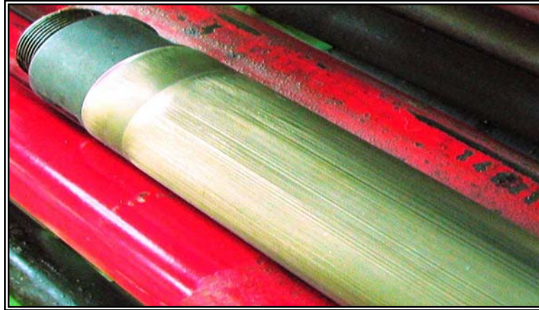
Figura D2. Pistón afectado por la arena
