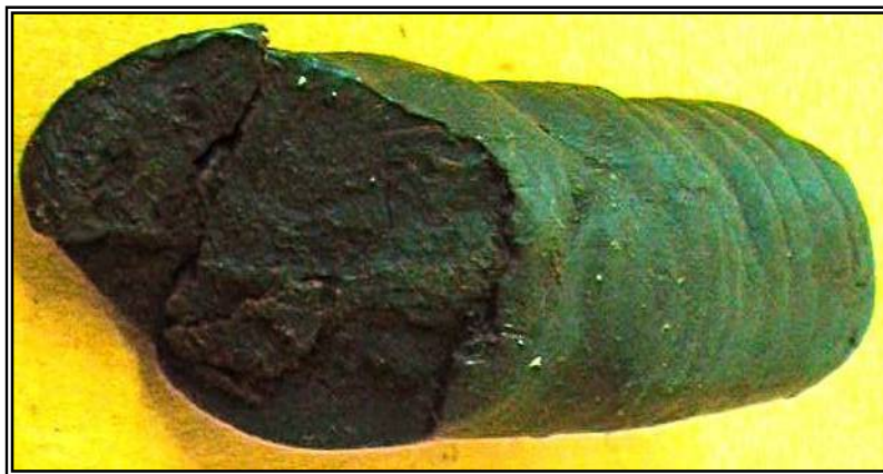
Figura D31. Parafina encontrada en la bomba
