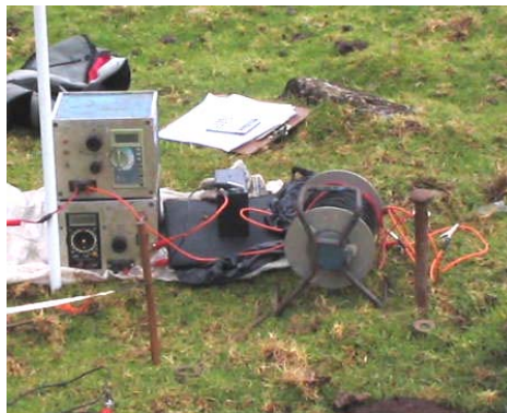
Foto 29. Equipo Utilizado en campaña de geoeléctrica
