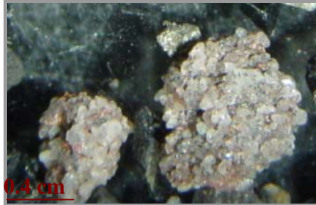
Fig. 15 Fragmento de Arenisca impregnda de bitumen del Uphole 2, 15 metros de profundidad, Formación Cuervos
