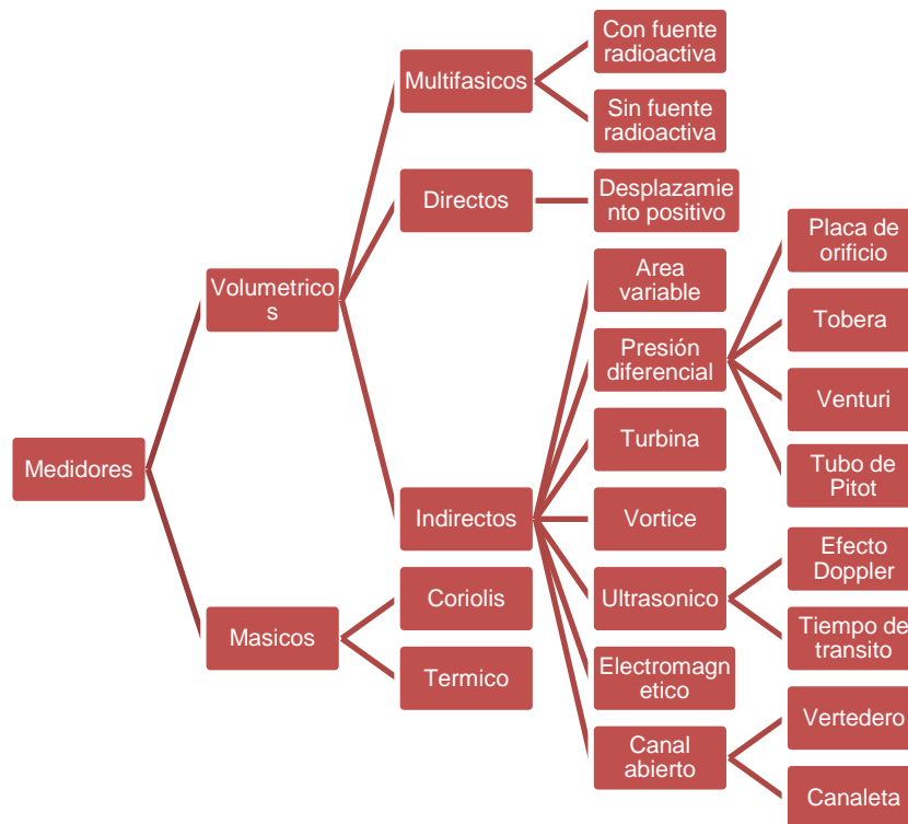
Figura 8. Clasificación de los medidores multifásicos.
