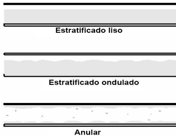
Figura 5. Flujo Separado en tubería horizontal.
