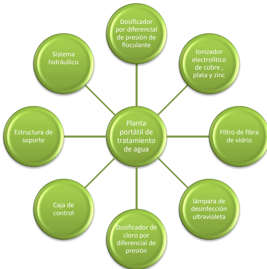
Figura 5. Subsistemas de la planta portátil de tratamiento de agua
