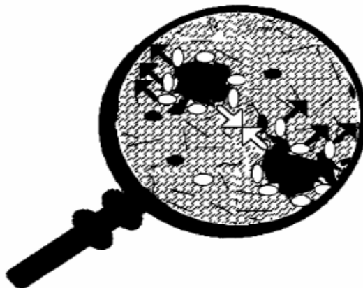
Figura 7. Migración de resinas de la superficie de los asfaltenos debido a la diferencia de potencial químico entre el seno del crudo y la superficie de las partículas.
