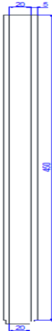
Figura 33. Sección 1 del tubo de descenso, dimensiones en mm.
