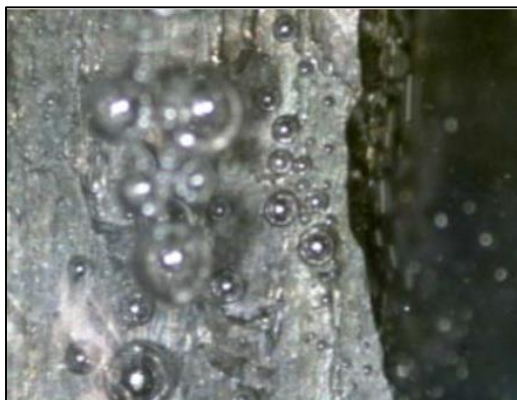
Figura 7. Imagen de microscopía de la formación de burbujas de gas en un carbón sub-bituminoso.
