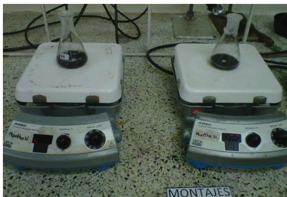
Figura 12. Montaje experimental de la funcionalización covalente de NTC-EDA y NTC-AF.
