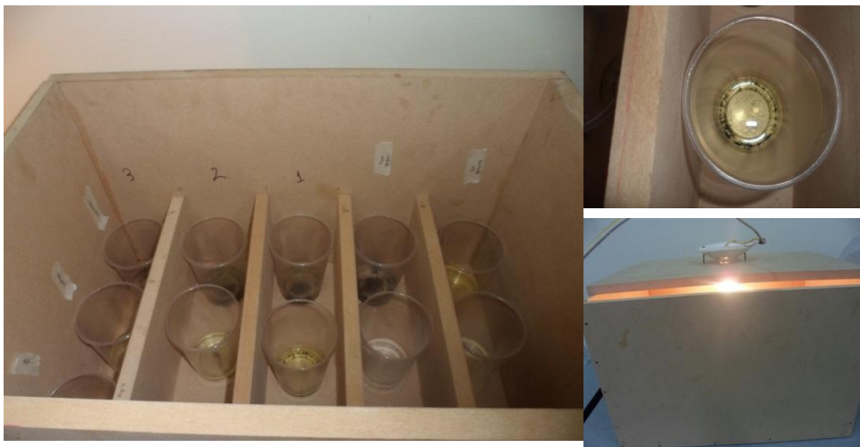
Figura 23. Montaje experimental efecto térmico en un sistema cerrado con lámpara incandescente de 60 watts.
