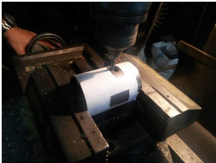
Figura 110. Maquinado de los agujeros de la camisa
