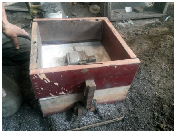
Figura 93. Molde de arena con caja superior listo para llenar y compactar
