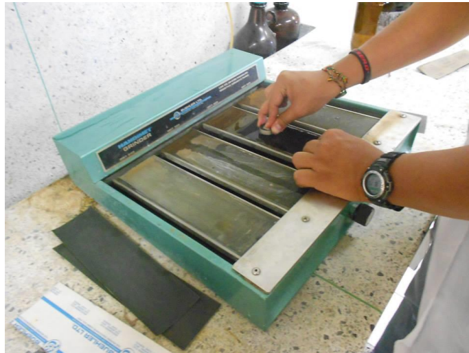
Figura 15. Proceso de desbaste con lija de agua
