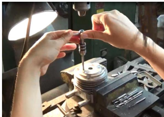
Figura 103. Elaboración de rosca de sujeción
