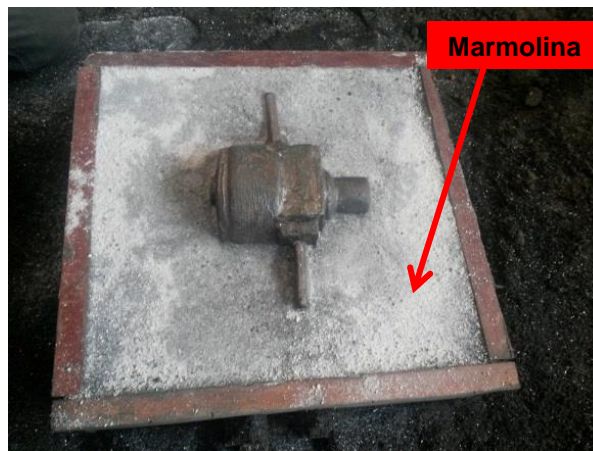
Figura 91. Molde con superficie de marmolina
