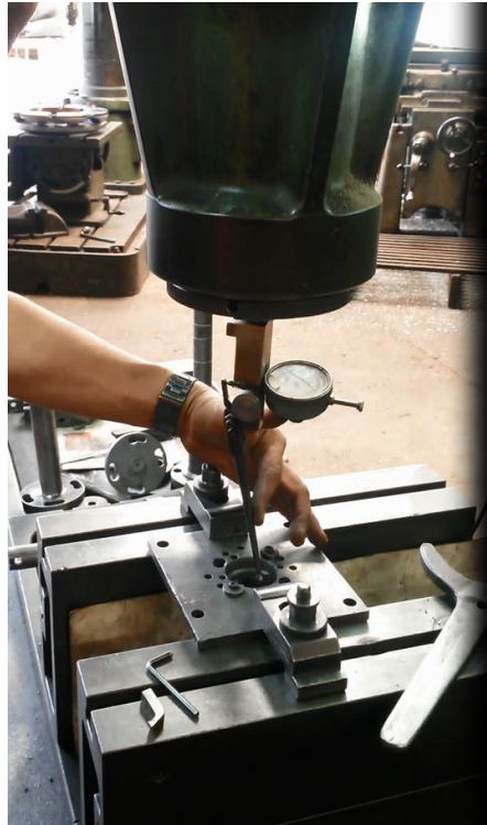
Figura 106. Alineación del cilindro mediante micrómetro de reloj.
