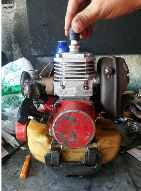
Figura 126. Montaje del cilindro prototipo en la unidad motriz Shindaiwa B450
