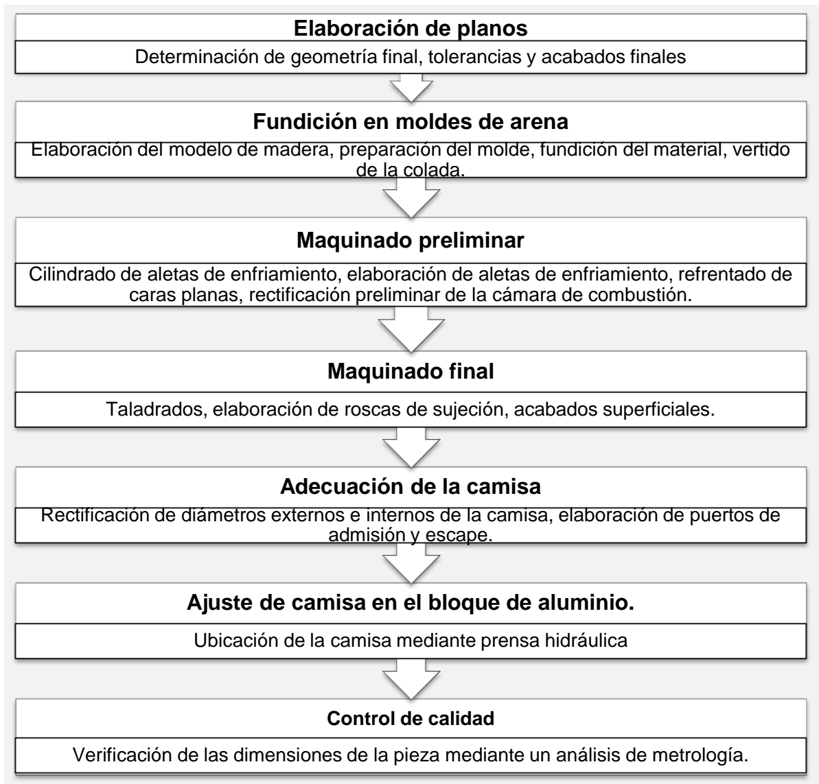
Figura 81. Proceso de manufactura del cilindro prototipo
