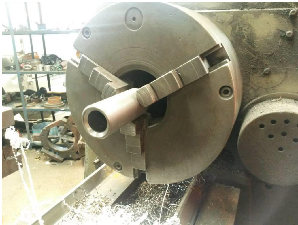
Figura 108. Preparación de la camisa mediante torno mecánico
