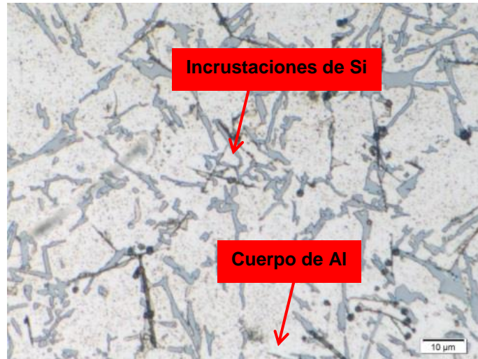
Figura 26. Probeta cuerpo bloque vista a 1500X, ataque Nital.
