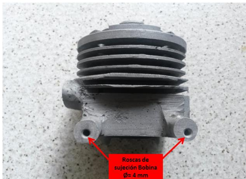
Figura 102. Taladrado vástagos de sujeción de la bobina
