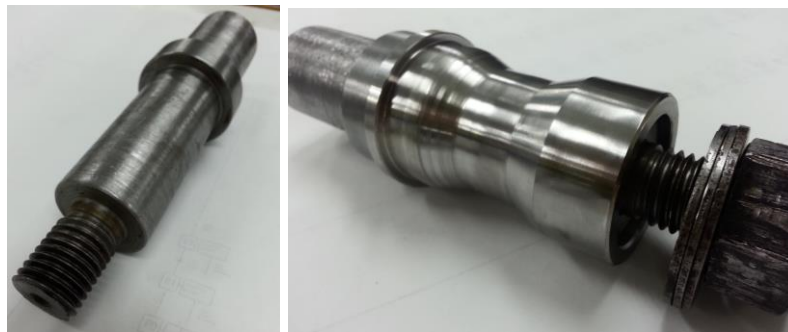
Figura 51. Manguito para montaje de celda en torno CNC
