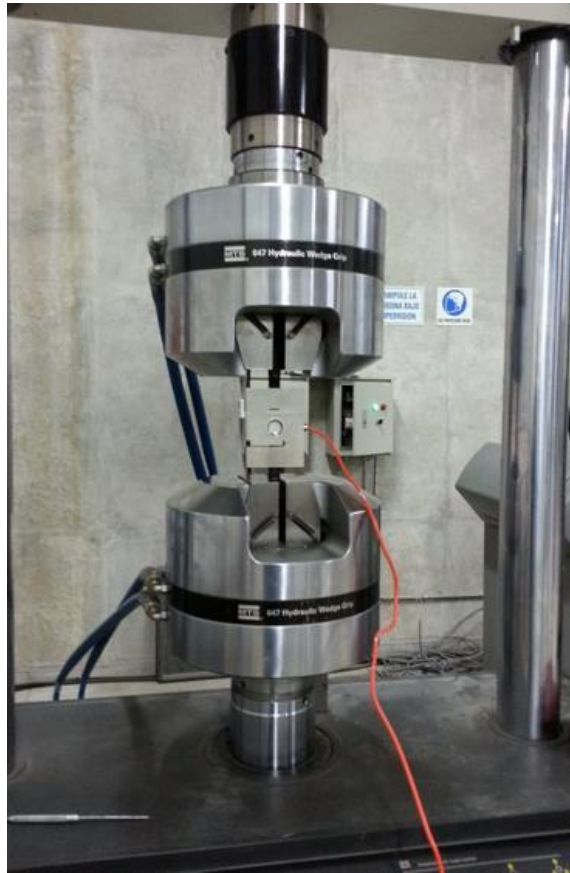
Figura 108. Celda de carga montada en MTS 810.
