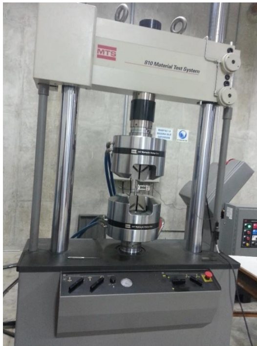
Figura 14. Máquina de ensayos universales MTS 810.
