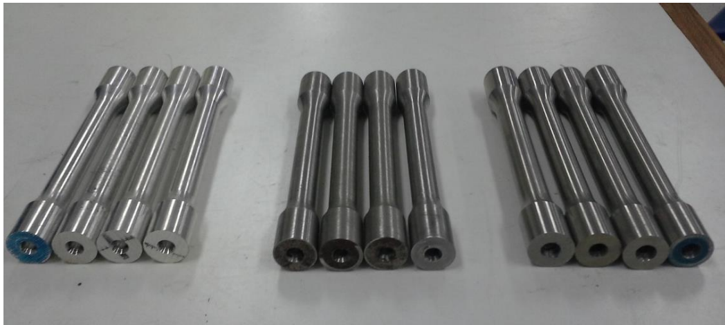
Figura 15. Probetas para pruebas de tensión.
