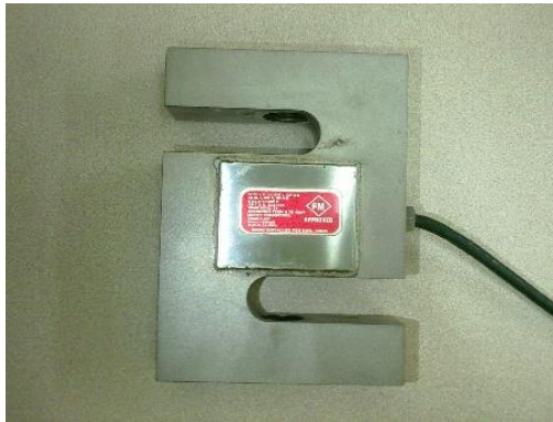
Figura 107. Celda de carga tipo S.
