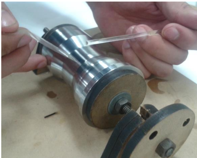
Figura 96. Aplicación del adhesivo para el pegado de la galga.
