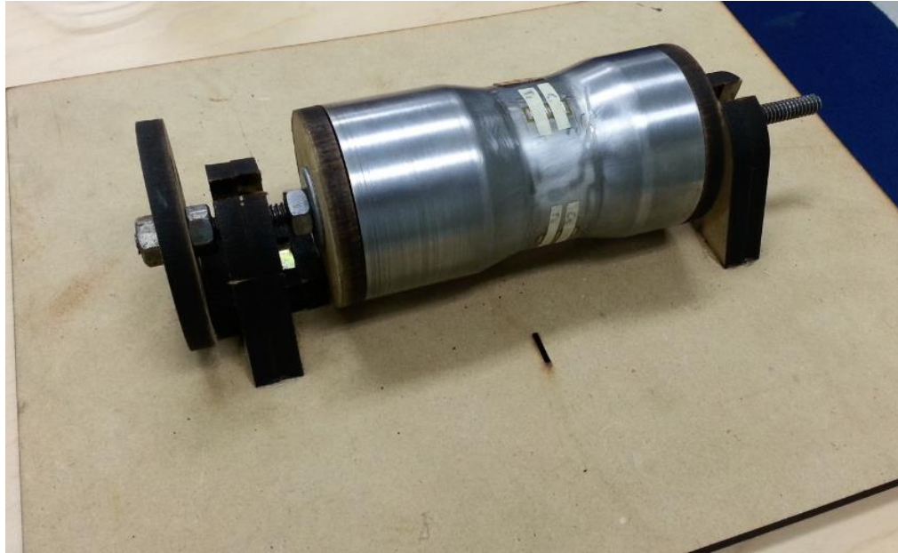
Figura 99. Celda lista para Soldar armado de puente de Wheatstone.
