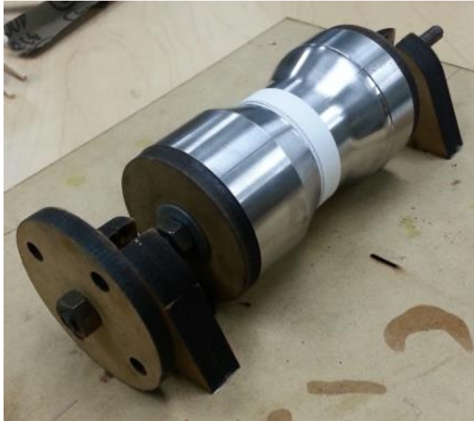
Figura 86. Montaje de la celda de carga en banco de pegado.
