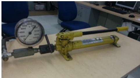
Figura 113. Bomba manual sistema Enerpac.
