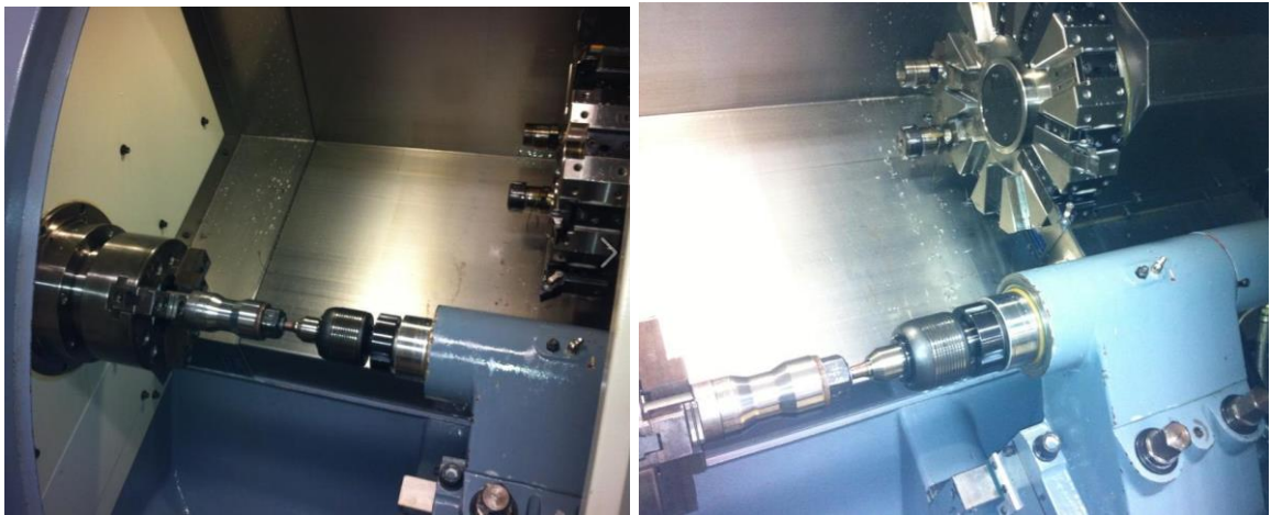
Figura 52. Mecanizado de celda de carga en torno CNC
