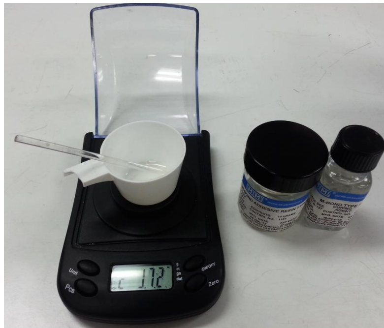
Figura 95. Pesaje y mezclado de los adhesivos.
