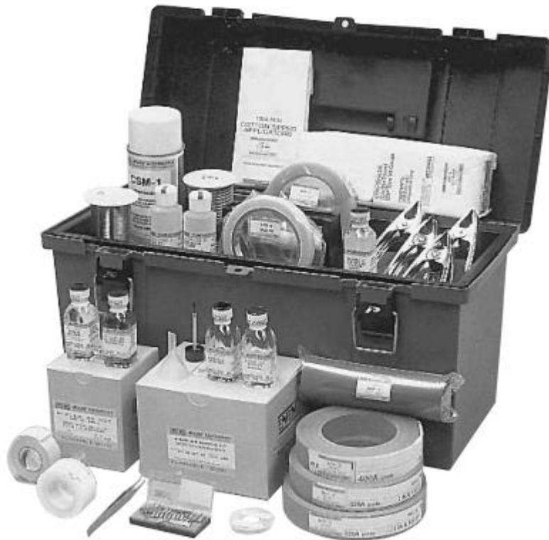
Figura 85. Kit de pegado de strain gages TAK-610
