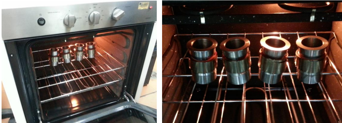
Figura 98. Celdas de carga en horno eléctrico
