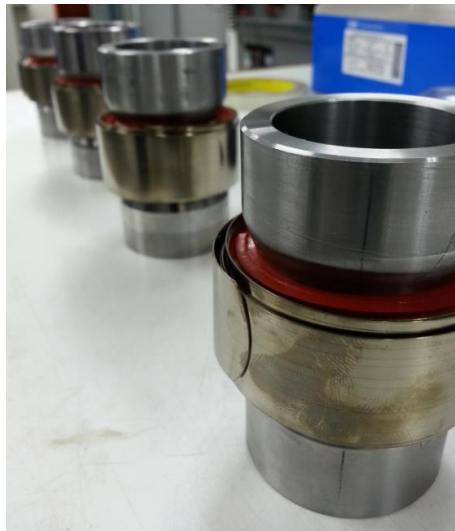
Figura 97. Celda de carga preparada para el curado
