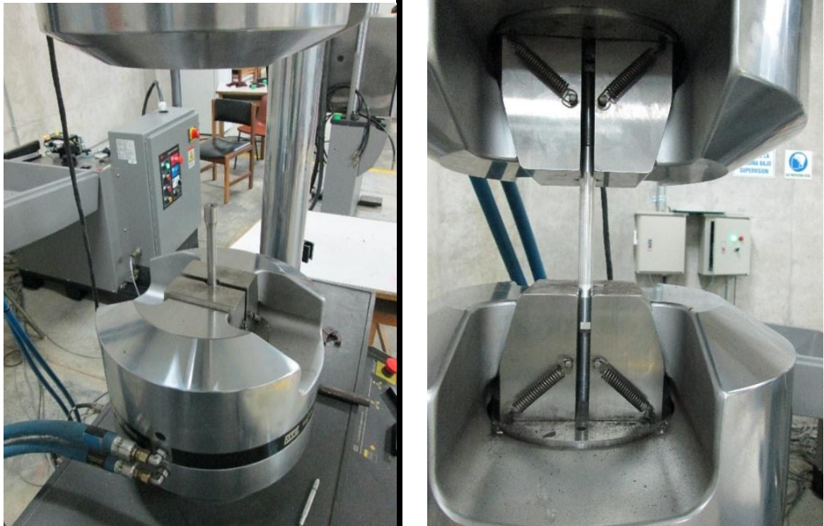
Figura 18. Montaje probetas en MTS 810
