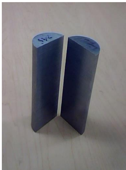
Figura 17. Corte longitudinal barra de acero para fabricación de probetas
