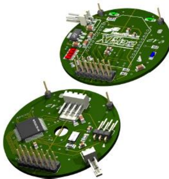
Figura 129. Tarjeta de adquisición de datos
