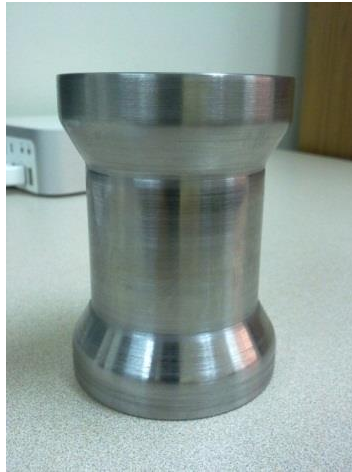
Figura 13. Prototipo de celda de carga.
