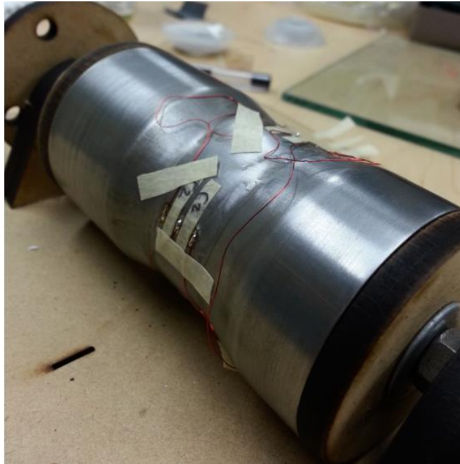
Figura 100. Armado de puente de Wheatstone en celda de carga.
