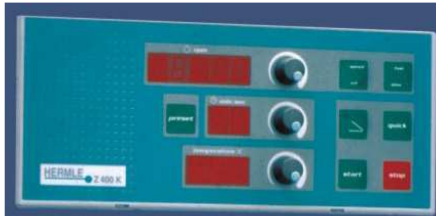
Figura 9. Tablero de control centrífuga Z300
