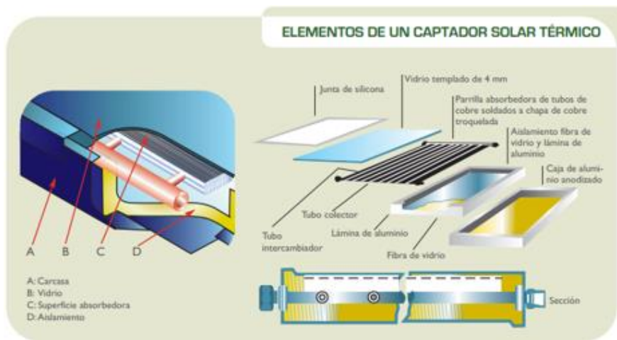
Figura 5. Capacitor Solar Térmico.
