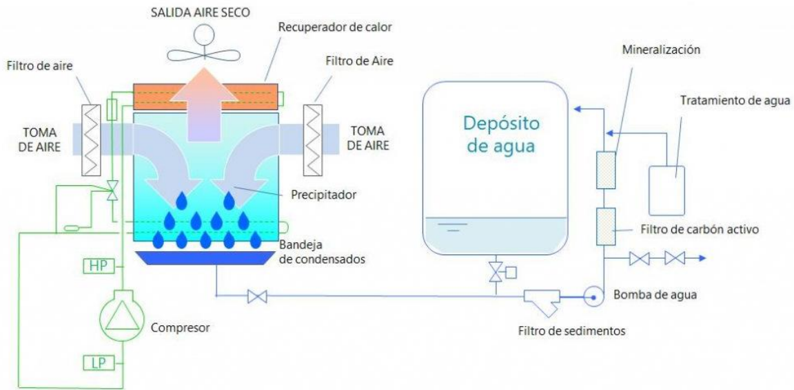
Figura 9. Funcionamiento de Dispositivo Generador de Agua Atmosférica
