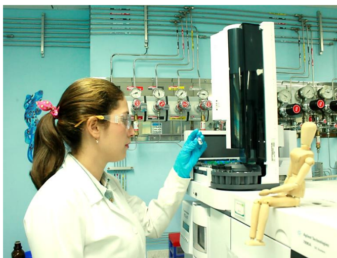
Figura 8. Cromatógrafo Agilent Technologies 7890A . Laboratorio instrumental CROM-MASS, UIS.
