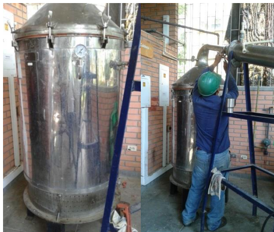
Figura 6. Equipo de destilación por arrastre con vapor de 1 m 3 de capacidad.
