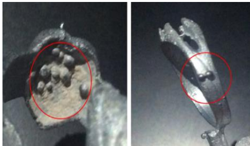
Figura 30. Poros presentes en el revestimiento con adición de PEG.
