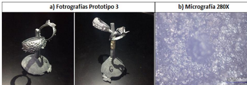
Figura 29. Acabado superficial del prototipo 3, mezcla: magnesita/yeso 60/40 con 60% de agua, 2% almidón de yuca.
