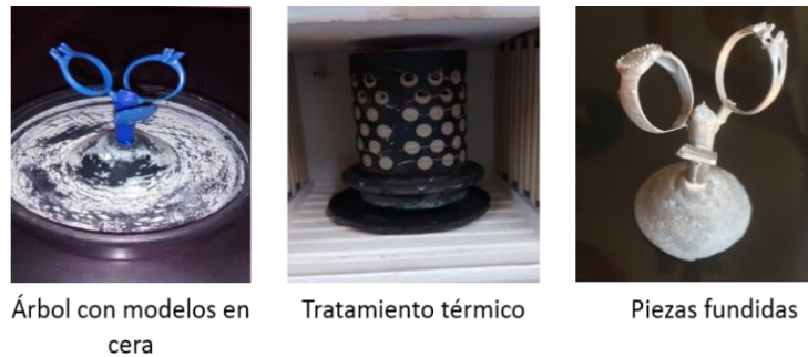
Figura 5. Fotografías del proceso de obtención de las piezas fundidas a partir del árbol de cera
