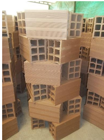
Figura 17. Secado natural en la empresa Ladrillos y Acabados S.A.S.
