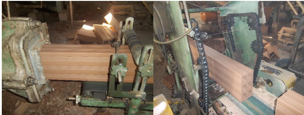
Figura 5. Moldeo y corte en la empresa Ladrillos y Acabados S.A.S.
