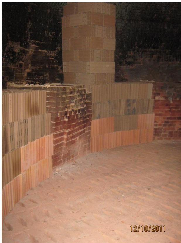
Figura 6. Etapa de carga en los hornos colmena.
