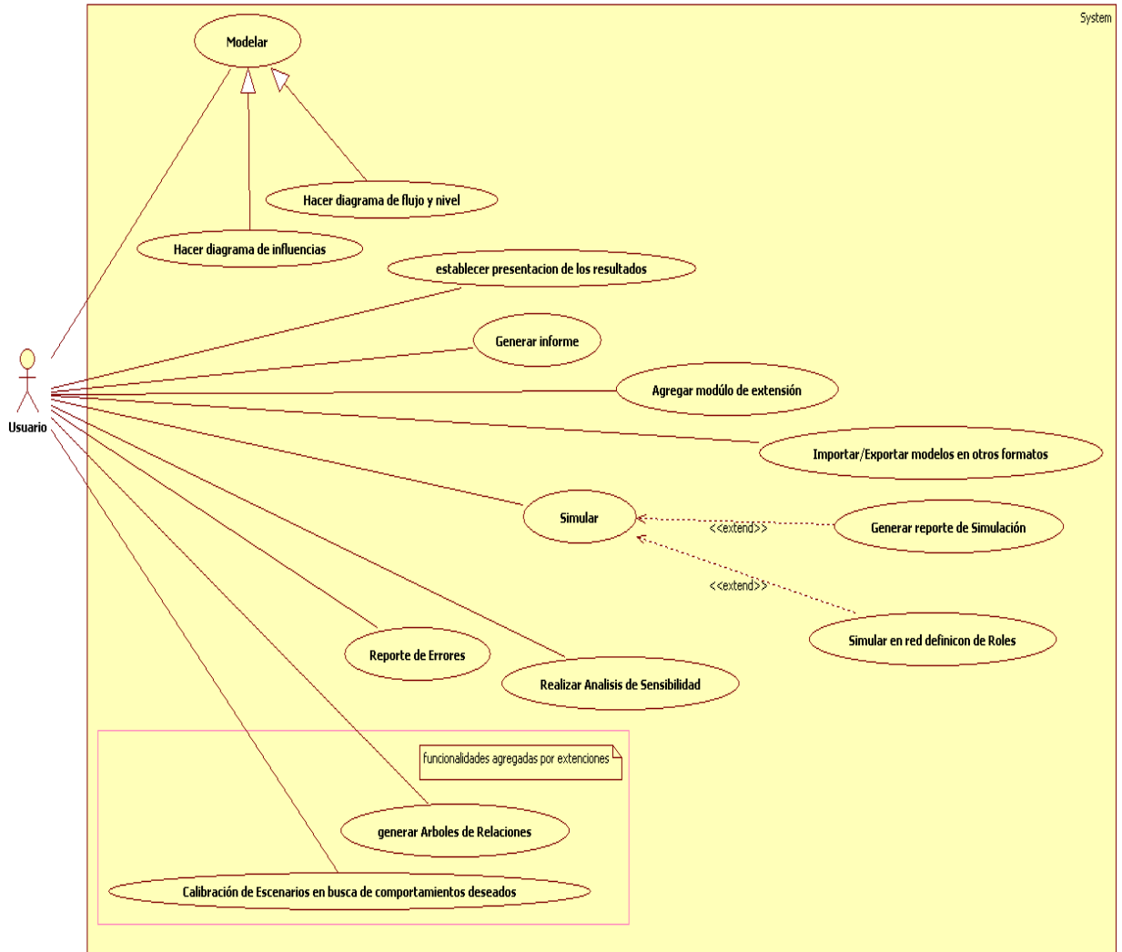
Figura 21. Requisitos funcionales de relevancia arquitectónica
