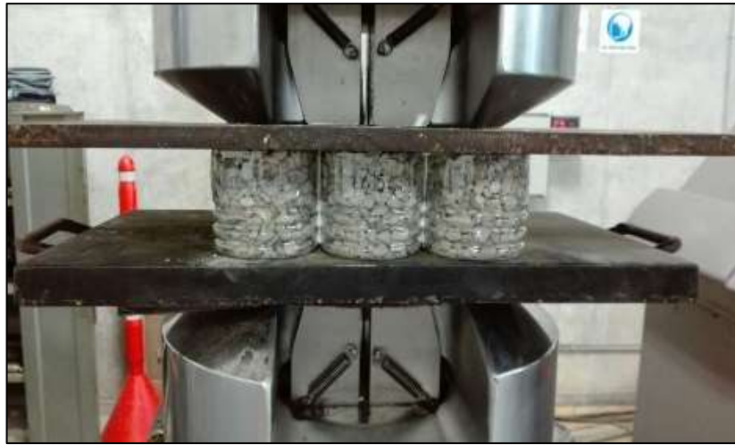
Figura 14. Ensayo de compresión en máquina MTS realizado a rejilla 3x3 para definir altura óptima
