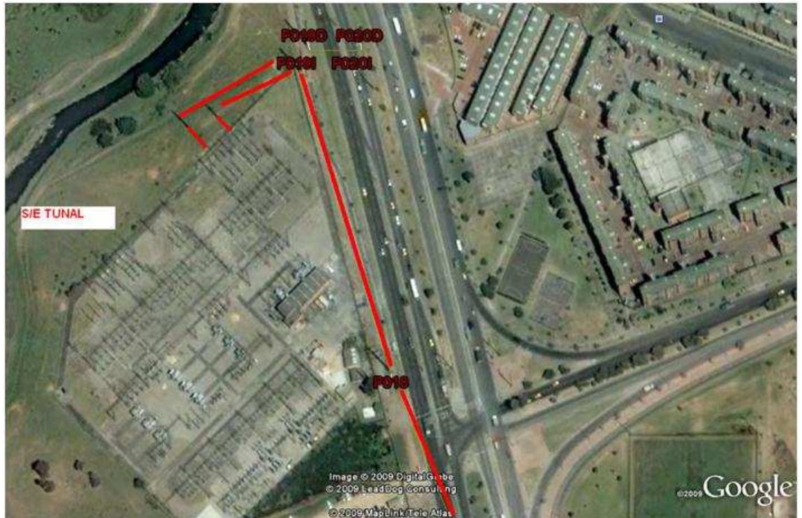
Figura 5. Llegada de la línea de transmisión Guavio-Tunal y Reforma-Tunal a la Subestación Tunal.
