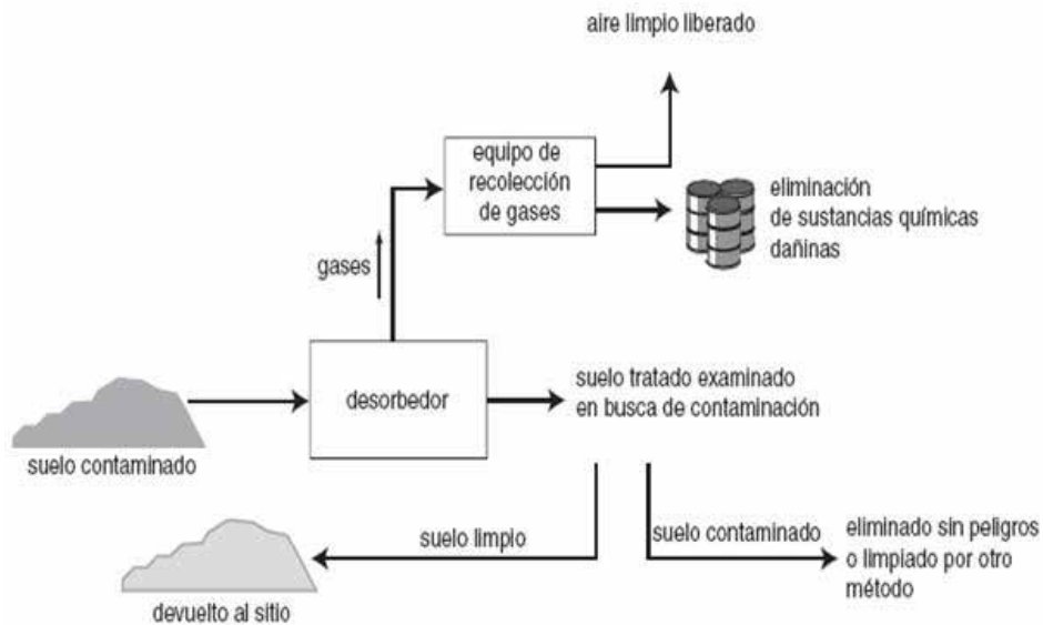
Figura 14. Esquema general del tratamiento de suelos por desorción térmica.
