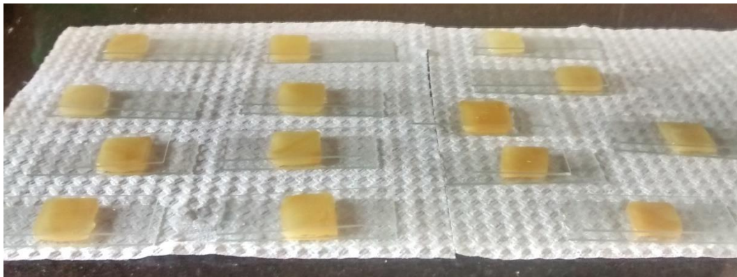
Figura 19. Secado de muestras de madera de balsa infiltradas con silicato de sodio en medio de dos portamuestras de vidrio.
