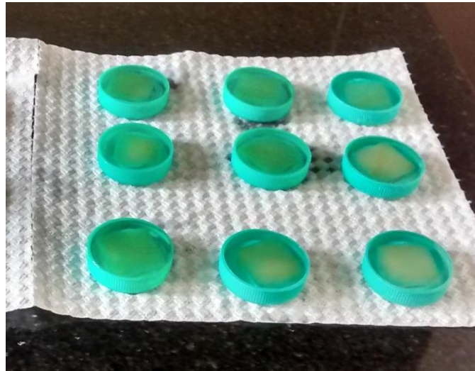
Figura 18. Secado en tapas plásticas de las muestras de madera de balsa infiltrada cubiertas con silicato de sodio.
