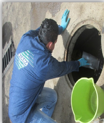
Figura 2 Toma de muestra del lodo de la Estación de servicio
